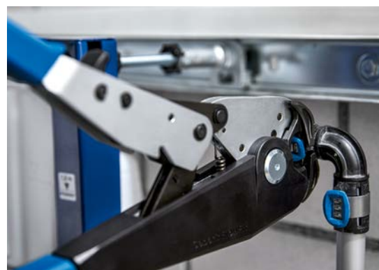
Handpresszange deckt fünf Dimensionen ab und braucht weder Strom noch aufgeladene Akkus.
