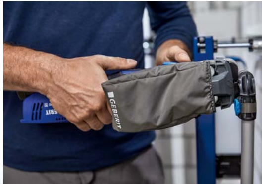
Beim Verpressen mit dem Auffangbeutel werden die Pressindikatoren direkt gesammelt und können als Masse in den Sammelbehälter entsorgt werden.
