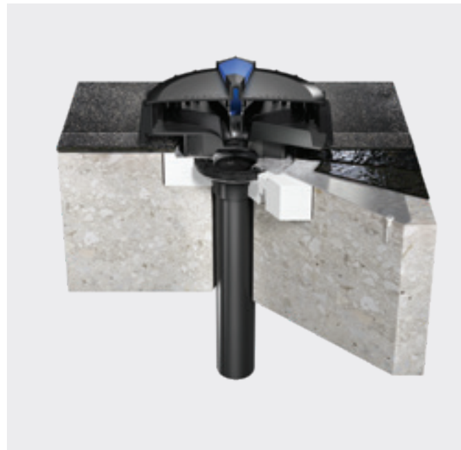
BEISPIEL 1: BETONDACH MIT BITUMEN-DACHABDICHTUNG Geberit Pluvia verfügt über ein Anschlussblech, das die Normgrösse übersteigt, und sorgt so für eine bessere Anbindung. Sowohl der Dachwassereinlauf für Folie als auch für Bitumen werden bauseitig direkt auf der Dachkonstruktion befestigt.
