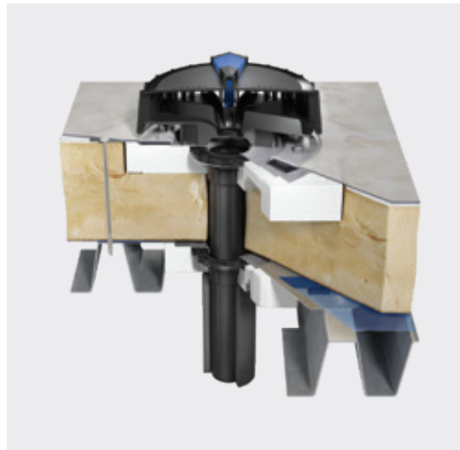
BEISPIEL 2: LEICHTBAUDACH, GEDÄMMT MIT DACHABDICHTUNGSFOLIE UND GEBERIT DAMPFSPERRENANSCHLUSS Leichtbaudächer profitieren von der geringen statischen Belastung durch Geberit Pluvia. Der Einbau erfolgt mit einer Flanschverbindung; dabei überwindet das lange Anschlussrohr mühelos auch große Dämmstärken. Der Geberit Dampfsperrenanschluss kann für Folie und Bitumen verwendet werden.
